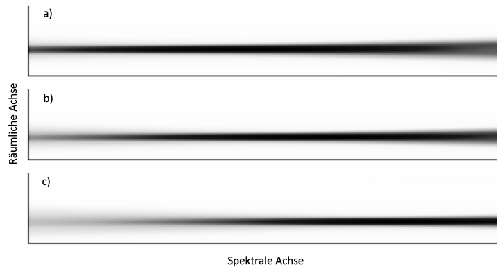
Abbildung 3.4: Abbildung einer Weisslichtquelle auf dem Chip. Auf der Abszisse ist die spektrale Achse aufgetragen, auf der Ordinate die räumliche Achse. Der Grauwert stellt die Intensität dar. Die drei Streifen zeigen drei unterschiedliche Fokuseinstellungen: a) Objektiv auf „fern“ fokussiert; b) Objektiv auf „mittel“ fokussiert; c) Objektiv auf „nah“ fokussiert. Wie man sieht, verschiebt sich durch Fokussieren der Punkt der schärfsten Abbildung entlang der spektralen Achse.
