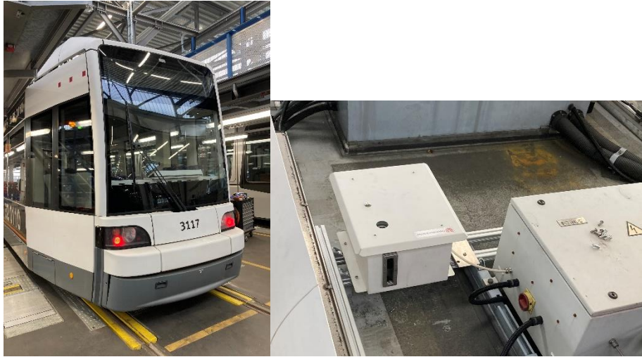
Abb. 6: Die Bremer Straßenbahn 3117 auf der das DOAS-Gerät betrieben wird (links) und der Aufbau auf dem Dach der Straßenbahn (rechts). Die beiden Fenster des Gerätes (oben für Zenitmessungen, vorne für Horizontmessungen) sind als dunkle Flächen zu erkennen. Die Blickrichtung der Horizontmessungen ist entgegen der Fahrtrichtung um Verschmutzungen zu vermeiden.
